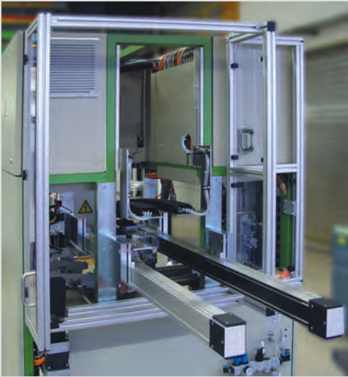
■ Palettierer PSU mit Doppelhandling Palet system PSU with twin handling
