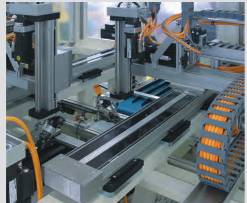
■ Mehrachshandling für die Produktentnahme Multiple axes handling for product removal
