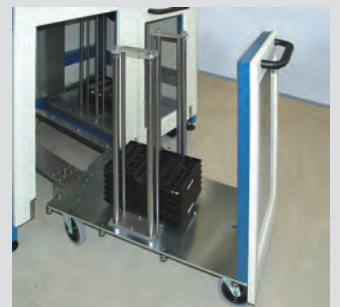
■ Palettenwagen mit Stapelführungen Pallet carriage with stack guiding
