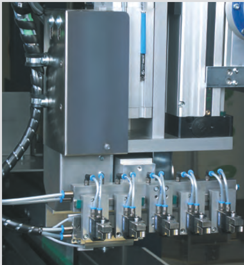
■ 5-fach greifer mit Rasterausgleich 5 fold gripper with grid compensation
