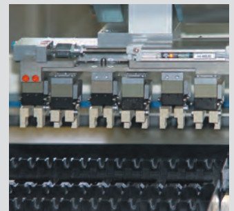
■ 6-fach Greifer mit Schwenk-und Ratserausgleichsfunktion 6 fold gripper with swivel and grid compensation function
