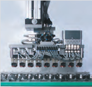
■ 9-fach Greifer 9 fold gripper
