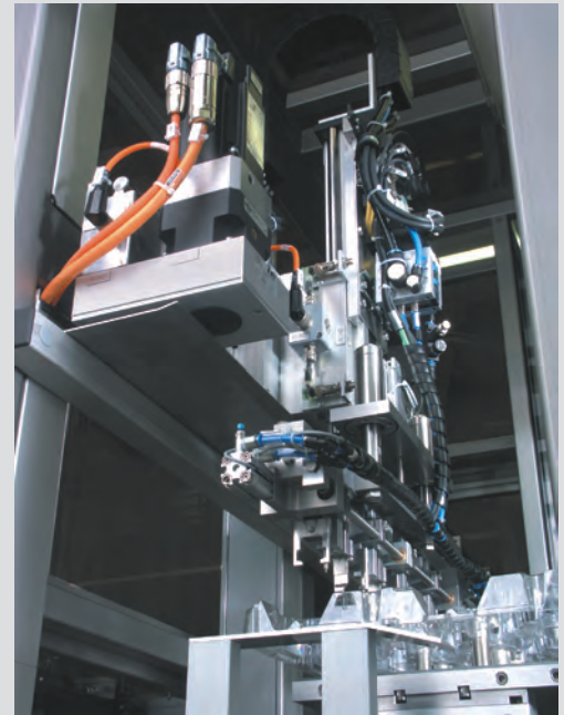
■ Produkthandling mit Mehrfachgreifer Product handling with multiple gripper
