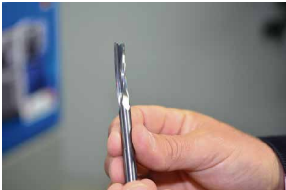
Här visas ett nytt verktyg som är slipat efter kunds önskemål. Det ingår nu i en ny serie verktyg som kan fräsa i både aluminium och plast i samma bearbetning.
