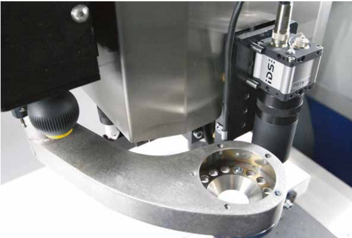
CleanCut suger ut spånor under bearbetningen och avlägsnar även restprodukter som uppstår vid bearbetning som t.ex. pertinax och andra ohälsosamma material som man skall undvika att andas in.
