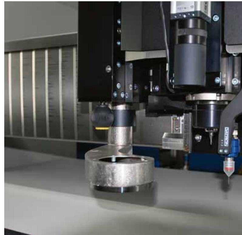
Här är en bild på en Z-axel som sitter på DATRON M10Pro. Z-axeln är utrustad med CleanCut, visionsystem och mätprobe. Visionsystemet hittar passmärken eller väldigt små hål för att linjera upp detaljen i XY axlarna. Mätproben mäter upp ytan eller mäter in detaljen.
