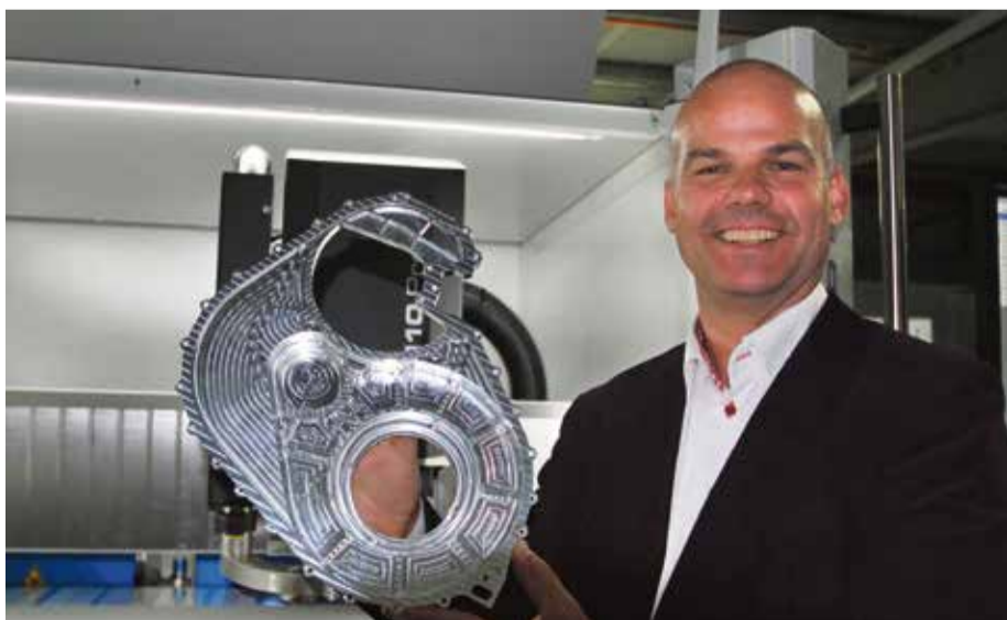
- Aluminiumdetalj till flygindustrin. När den här kunden bytte till en DATRON CNC-maskin sänkte han sin bearbetningstid från 60 minuter ("traditionell" CNC-maskin) till 35 minuter. Efter ytterligare optimering av detaljens bearbetning så är man idag nere på 25 minuter. Alltså har man lyckats att halvera detaljens bearbetningstid säger Mattias och tillägger: "Kunden fick dessutom en kvalitetsförbättring som var bättre än kundkravet".
