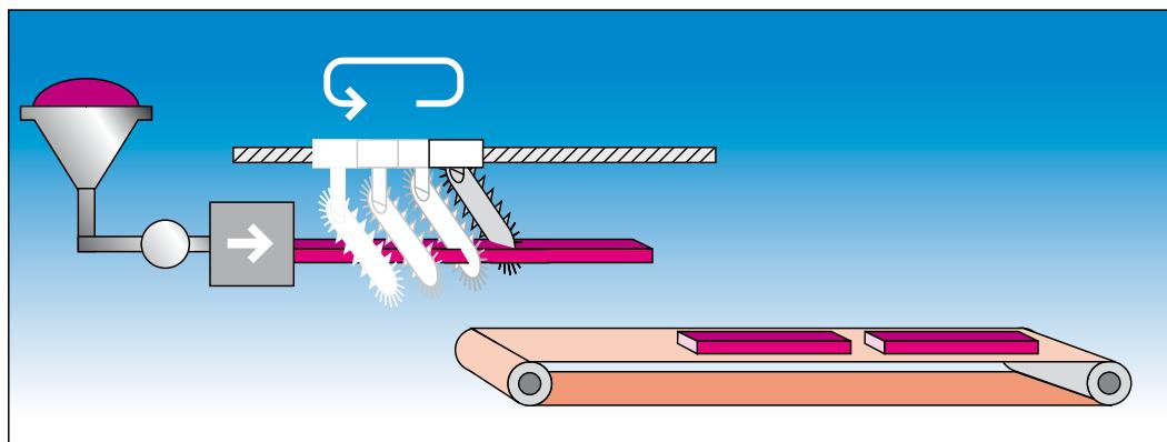
**„Fliegende Säge“ „*Flying Shear*“**
